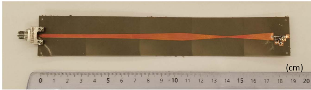
Fig. 7. Octave bandwidth rectifier prototype.
